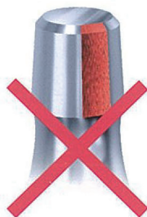
広範囲でのステムネックテーパー部の断裂
